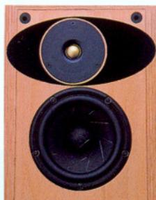
バッフル面は板厚22mmの積層材を用いられている。トゥイーターには、トランジエントと周波数特性を向上させるため、シルク振動板の表面に金属コーティングを施した1.9cmソフトドーム型を搭載。ウーファーはスキャンスピーク製12.7cmコーン型ユニットをベースとしたもので、振動板の強度をあげるなど、独自のチューンナップが施されている。
